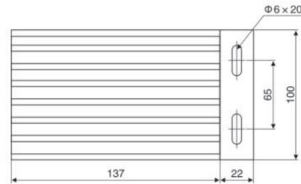
**产品概述:** JRD2型铝合金梳装加热器是专为电力设备除潮除湿设计的新型电热器。该加热器采用了专用的铝合金散热板型材和优质的合金电热丝组成。它体积小、外型美丽、散热均匀、热传导快、散热面积大等特点，从而保证电热丝的使用寿命比一般加热器长很多，可以长期可靠的工作。
